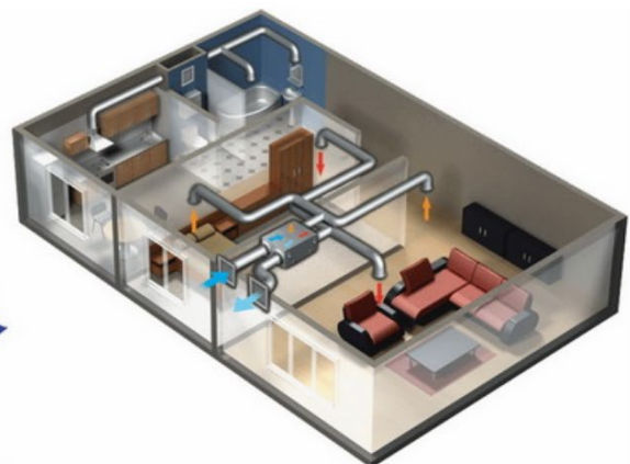
Figura 10. Diagrama de principio y visualización en 3D del sistema de recuperación de calor.
