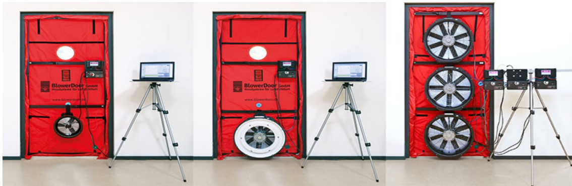
Figura 7. Tipos de equipos de prueba de puerta sopladora según la potencia requerida.
