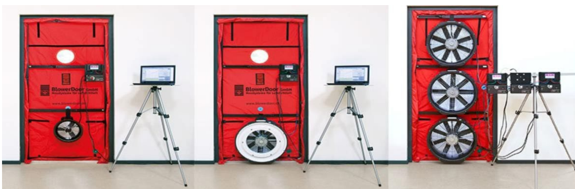
Figura 7 Tipuri de echipamente de testare Blower Door în funcție de puterea necesară.
