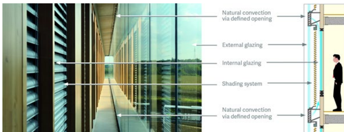
Figur 9: Dobbeltskinnet fasade
