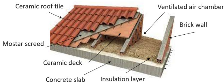
Figura 7: Acoperiș cu țiglă și pereți din cărămidă
