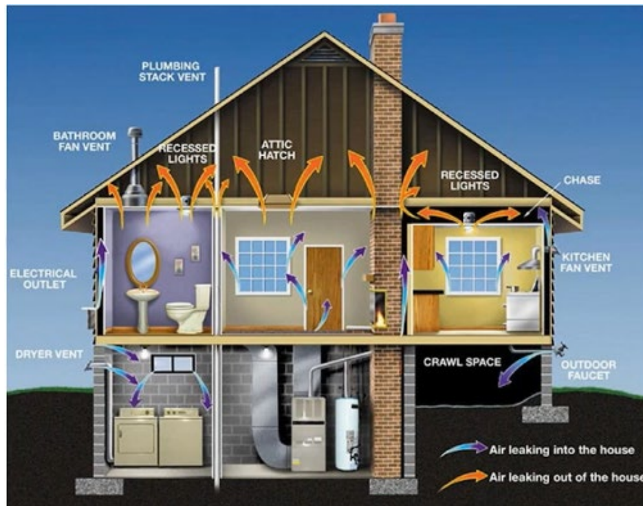
Figura 10: Fuga de aire hacia el interior/ exterior de la vivienda[3].
