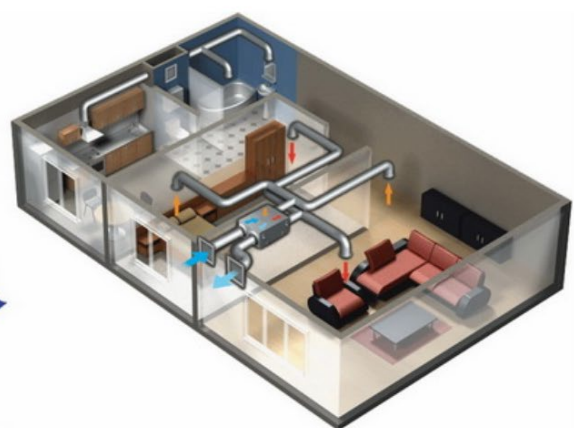
Figur 10 Prinsippskisse og 3D-visualisering av varmegjenvinningssystemet.
