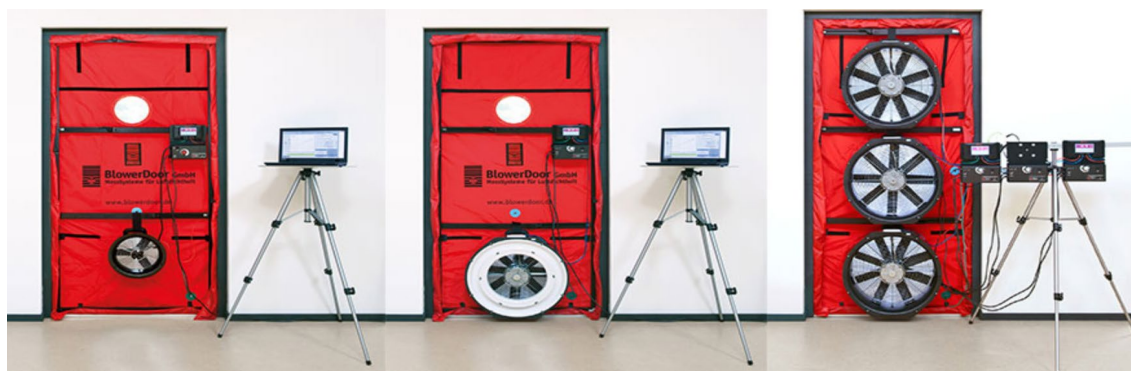
Figur 7 Typer av utstyr for blåsetest i henhold til nødvendig effekt.
