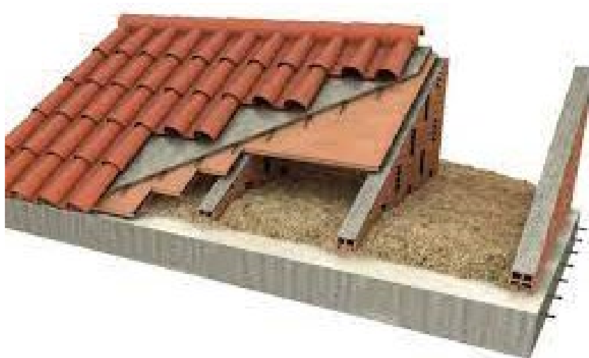
Figur 12: Tak med murvegger (ventilert tak).
