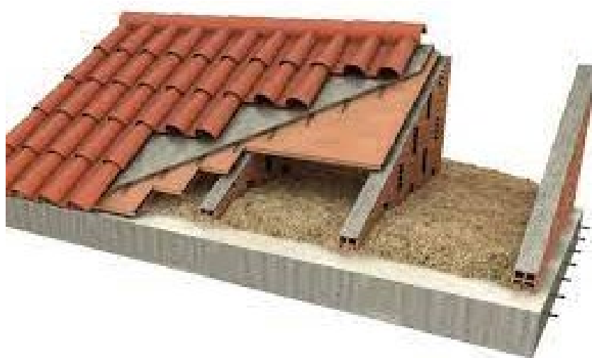
Figura 12: Acoperiș cultivat cu pereți din cărămidă (acoperiș ventilat).
